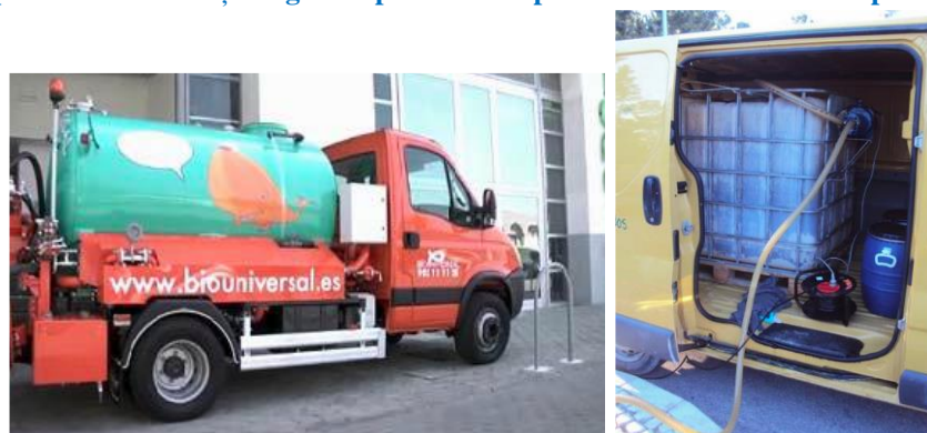
Figura 7-14 Tipuri de camioane și furgonete pentru transportul uleiurilor uzate din punctele de colectare
